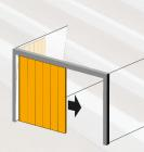
Las puertas y portones correderos deberán ir provistos de un sistema de seguridad que les impida salirse de los carriles y caer. Las puertas y portones de apertura vertical estarán dotados de un sistema de seguridad que impida su caída (los sistemas de bloqueo o de seguro manual instalados en portones plegables basculantes de apertura manual, en ningún caso pueden considerarse sistemas anticaídas).
